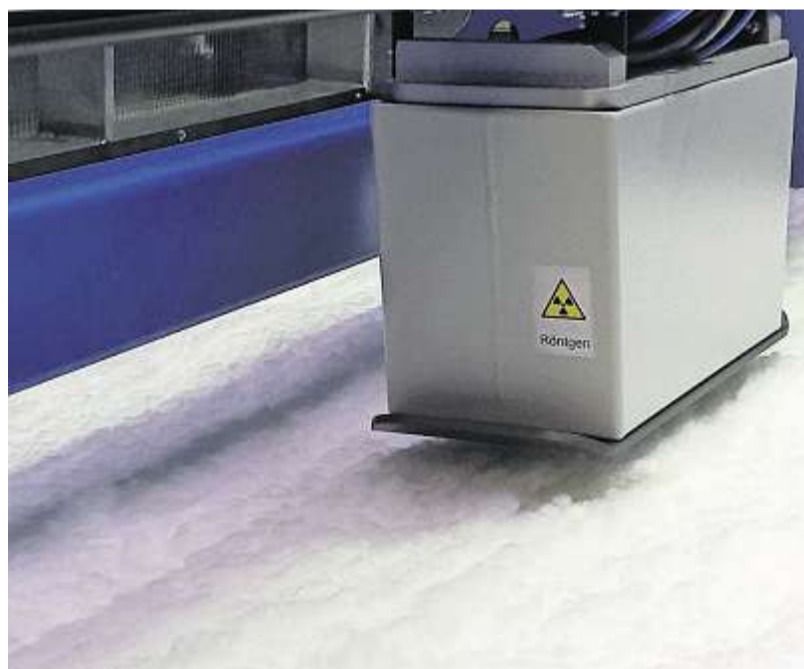
Mit dem neuen System wird auch die Flächenmassenmessung dicker Bahnenware – wie hier im Bild Vlies – einfacher und zuverlässiger. Foto: ZAP
